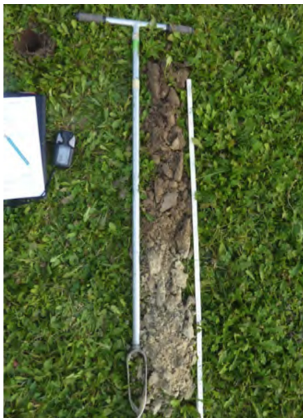
Sondage à la tarière et détermination du type de sol, de sa sensibilité à la compaction et de ses caractéristiques agricoles
